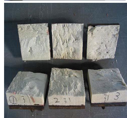
図一解 2.4 引張試験後の供試体 (100℃、60 年)
